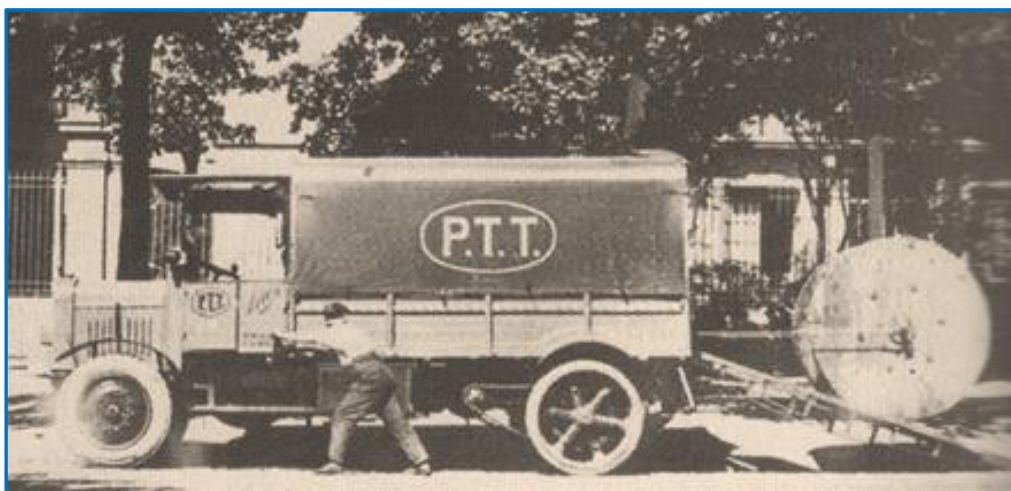
Camionnette 14 CV transportant deux tourets de câbles et est dotée d'une dérouleuse
