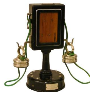
Coll. Collection Historique d'Orange Téléphone à plaque vibrante D'Arsonval, 1898
